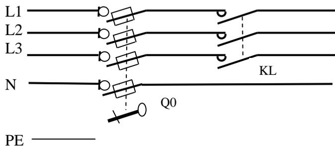
**PARTIE C Schéma de puissance du dégrilleur**
