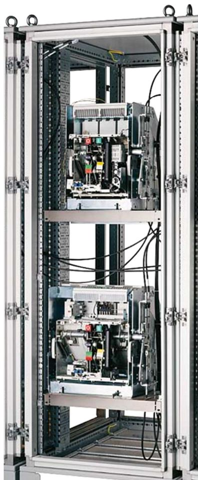
L'ensemble des DMX<sup>3</sup> peuvent être équipés d'un kit d'interverrouillage qui garantit une « sécurité mécanique » en cas d'une utilisation en inverseur de sources. Les liaisons entre les DMX<sup>3</sup> sont assurées par un système de câbles et de mécanismes d'interverrouillage fixés sur chaque appareil.
