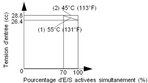
Aussi, lorsque vous utilisez les bases mentionnées ci-dessus à 45°C (113°F), toutes les entrées et sorties peuvent être activées simultanément à une tension d'entrée de 28,8 V cc comme indiqué par la ligne (2).
