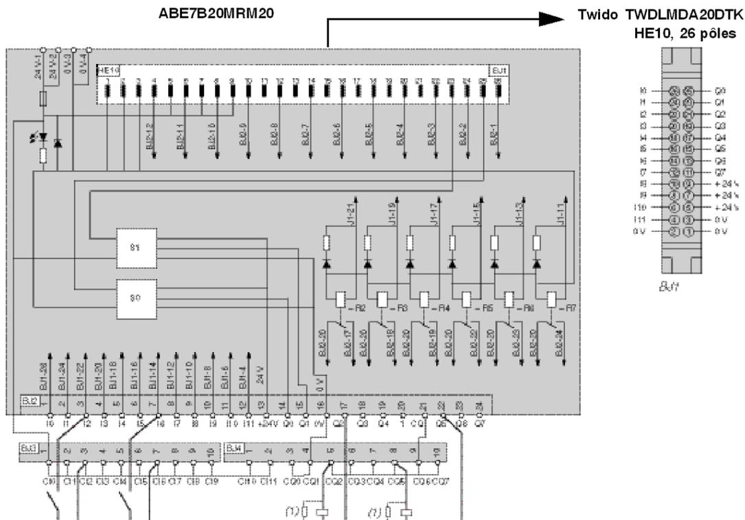
(1) Exemple de connexions en sortie.
