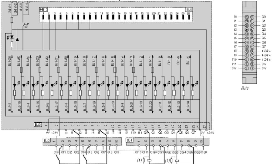
(1) Exemple de connexions en sortie.
