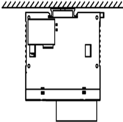
Si la température ambiante ne doit pas dépasser 35°C (95°F), les bases compactes peuvent être montées verticalement sur un plan vertical, comme représenté ci-après :
