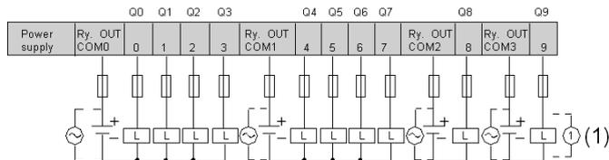
Ce schéma de câblage s'applique aux bases TWDLC••40DRF.
