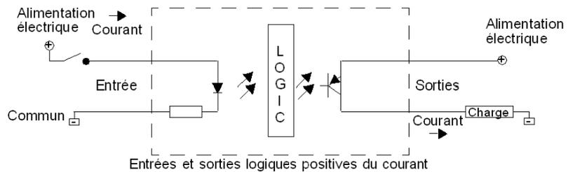
Le bornier COM côté entrée est connecté au pôle négatif (-) ou au commun de l'alimentation. Le bornier COM côté sortie est connecté à l'alimentation +24 V.
