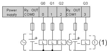
Ce schéma de câblage s'applique aux bases TWDLC•A16DRF.
