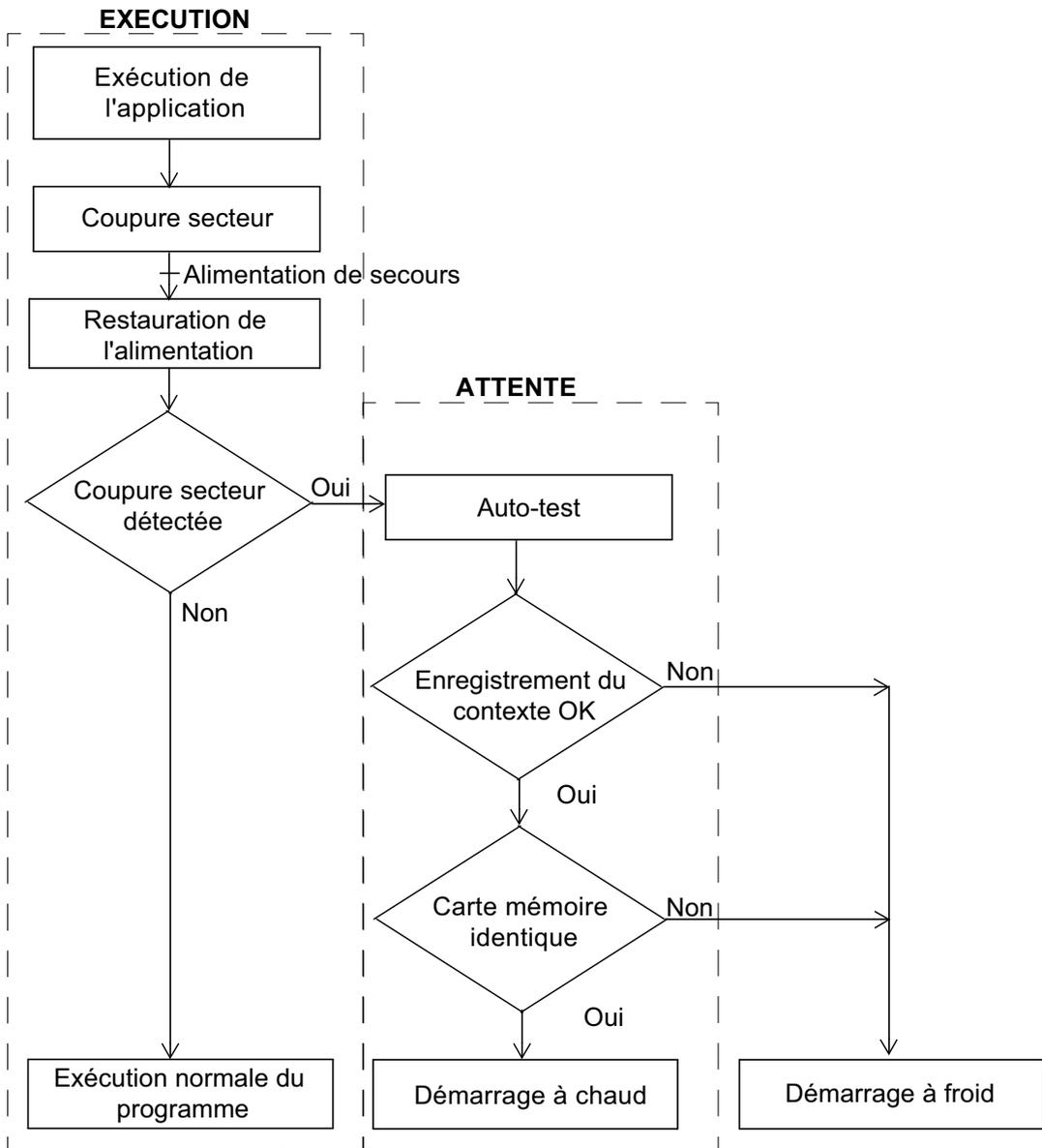
**NOTE :** Le contexte est enregistré dans une mémoire RAM sur batterie de secours. A la mise sous tension, le système vérifie l'état des batteries et du contexte enregistré afin de déterminer si un démarrage à chaud est possible.
