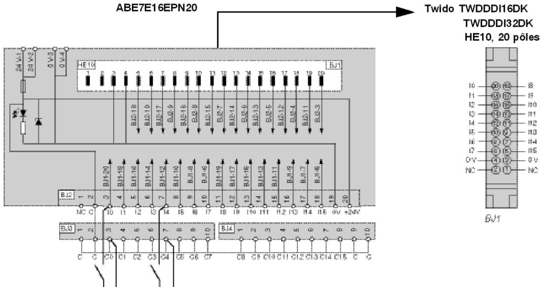
(1) Exemple de connexions en sortie.
