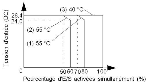
Lorsque vous utilisez les automates TWDLMDA40DUK et TWDLMDA40DTK, limitez l'utilisation simultanée des entrées et des sorties comme indiqué par la droite (2).
