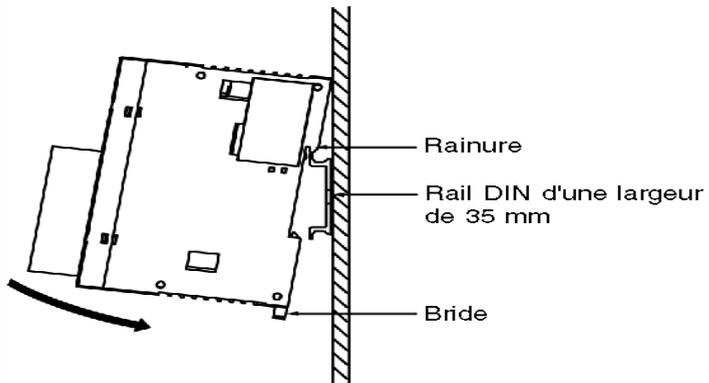
**Retrait d'une base compacte d'un rail DIN**
