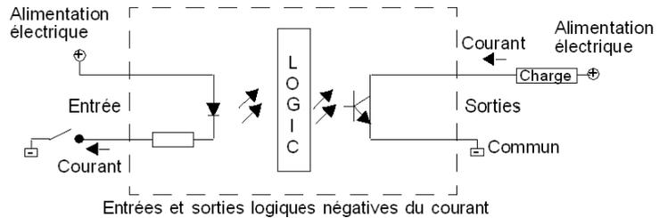
Le bornier COM côté entrée est connecté à l'alimentation +24 V. Le bornier COM côté sortie est connecté au pôle négatif (-) ou au commun de l'alimentation.
