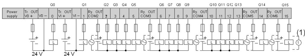
**La polarité inversée au niveau de la sortie transistor n'est pas autorisée**
