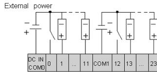
Le schéma de câblage d'entrée source c.c. suivant s'applique aux bases de la série TWDL $\bullet\bullet$ 40DRF (alimentation interne).
