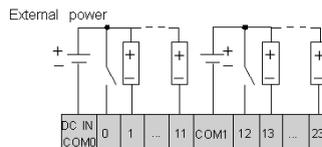
Le schéma de câblage d'entrée sink c.c. suivant s'applique aux bases de la série TWDLC••40DRF (alimentation interne).
