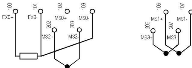
**Légende :** Fonctionnement en mode TC avec compensation de soudure froide à l'aide d'une sonde PT100 à 3 fils.
