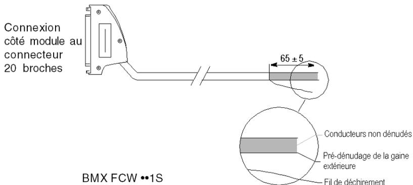
**NOTE** : un brin en nylon intégré au câble permet de retirer facilement la gaine.
