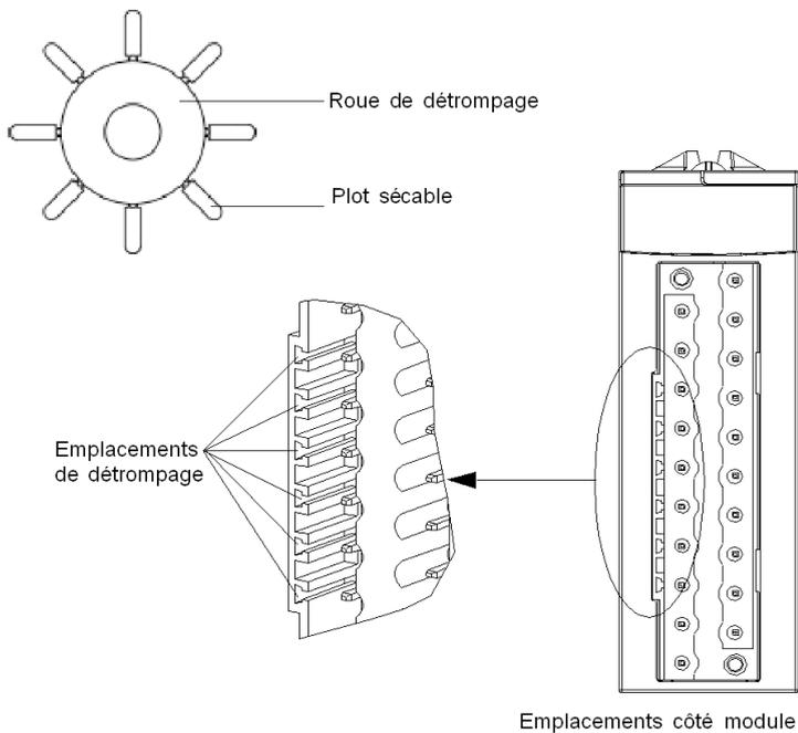
Le schéma ci-après présente un exemple de configuration de codage permettant de fixer le bornier au module :
