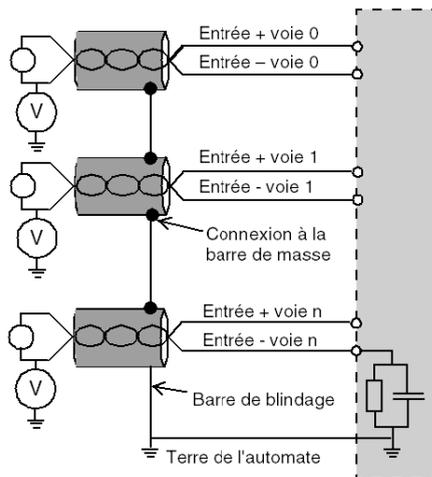
Si les capteurs sont référencés par rapport à la terre, cela peut, dans certains cas, ramener un potentiel de terre éloigné sur le bornier. Il est donc **impératif** de respecter les règles suivantes :
