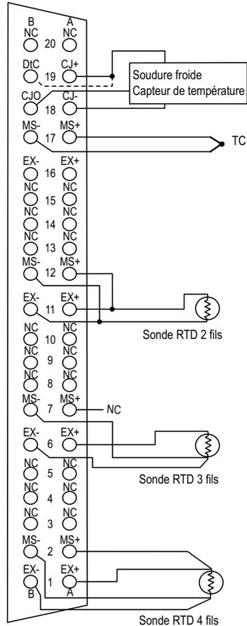
**MS+** : entrée + de la mesure RTD / Entrée + thermocouple
