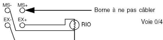
**NOTE :** pour le module BMX ART 0814, les valeurs CJC des voies 4 à 7 peuvent également être utilisées pour les voies 0 à 3. Ainsi, un seul capteur externe CJC ([voir page 137](#)) est raccordé à la voie 4.
