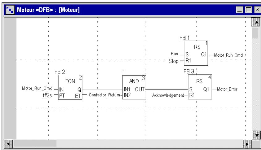
Lorsque Run = 1 et Stop = 0, le moteur peut être contrôlé (Motor\_Run\_Cmd = 1). L'autre partie permet de surveiller la variable Contactor\_return. Si Contactor\_return n'est pas réglée sur "1" une fois que deux secondes se sont écoulées au compteur TOR, la sortie Motor\_error passe à "1".
