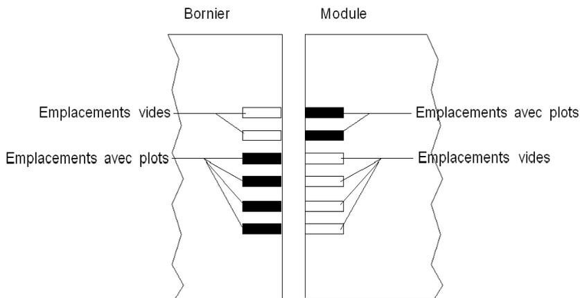
Le schéma ci-après présente un exemple de configuration de codage ne permettant pas de fixer le bornier au module :
