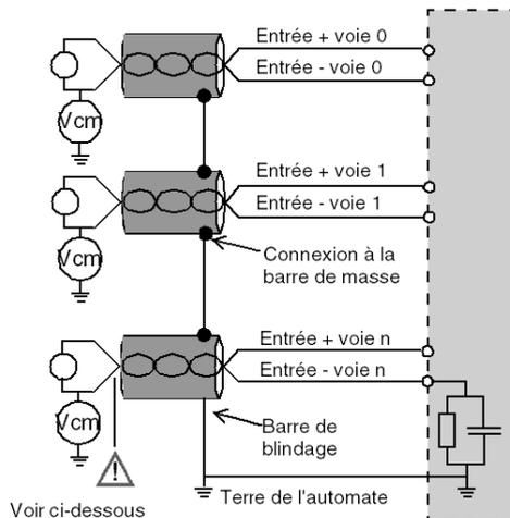
Si les capteurs sont référencés par rapport à la terre, cela peut, dans certains cas, ramener un potentiel de terre éloigné sur le bornier ou le connecteur FCN. Il est donc impératif de respecter les règles suivantes :
