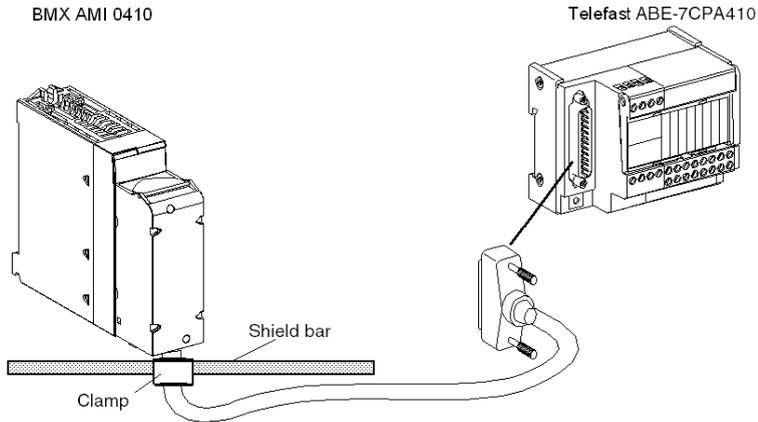
Le module analogique BMX AMI 0410 peut être raccordé à l'accessoire TELEFAST ABE-7CPA410 à l'aide d'un des câbles suivants :
