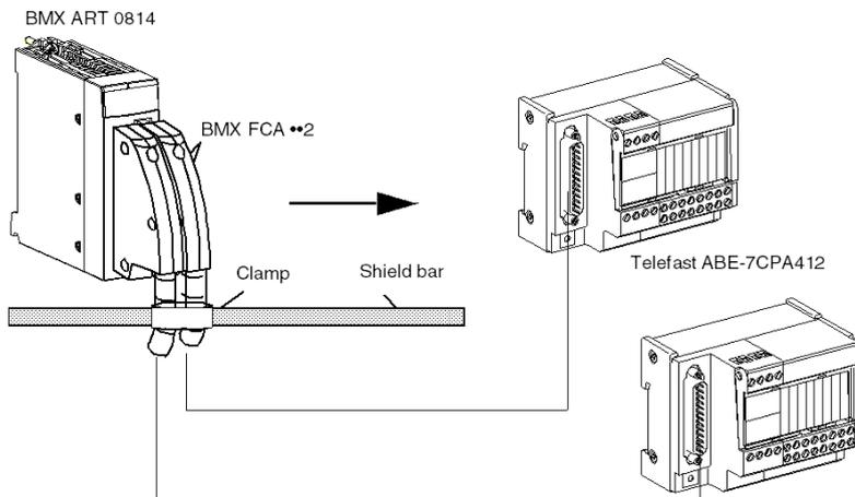
Le raccordement des modules analogiques BMX ART 0414/0814 à l'accessoire TELEFAST ABE-7CPA412 s'effectue à l'aide de l'un des câbles suivants :
