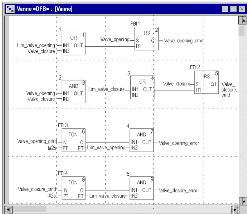
Ce DFB autorise la commande à ouvrir la vanne (Valve\_opening\_cmd) lorsque les entrées Valve\_closure et Lim\_valve\_opening sont réglées sur "0". Le principe est similaire pour la fermeture, avec un dispositif de sécurité supplémentaire si l'utilisateur demande l'ouverture et la fermeture de la vanne en même temps (l'ouverture est prioritaire).
