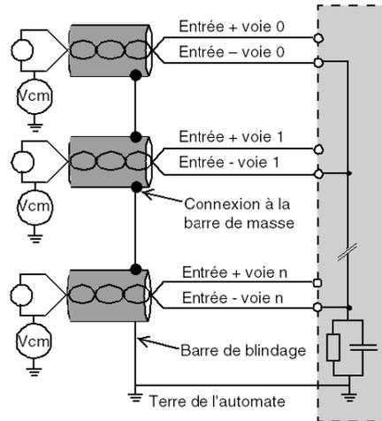
Si un ou plusieurs capteurs sont référencés par rapport à la terre, cela peut, dans certains cas, ramener un courant de terre éloigné sur le bornier et perturber les mesures. Il est donc **impératif** de respecter les règles suivantes :
