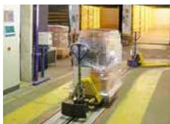
Pesage en convoyeur à chaîne au sol
