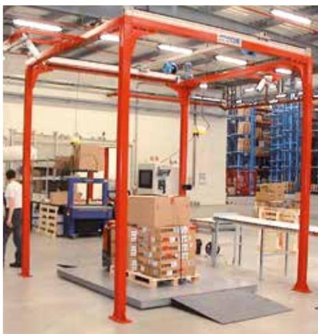
Cadre de mesure volumétrique, balance au sol avec rampe d'accès
