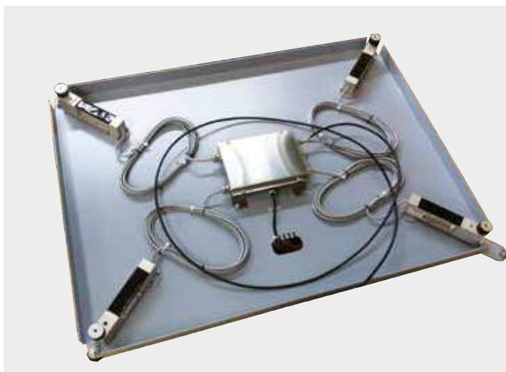
Structure de la balance avec 4 capteurs
