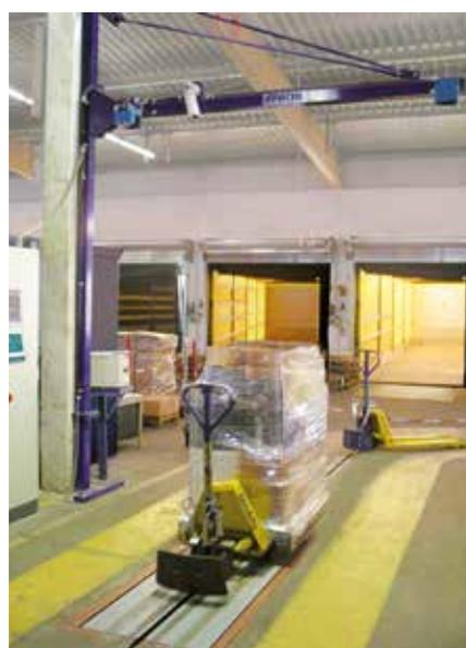
Convoyeur à chaîne au sol
