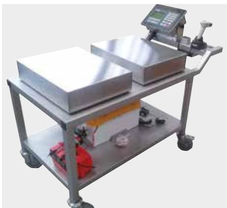
Double balance sur structure mobile avec roues, scanner à code-barres et alimentation pur batterie
