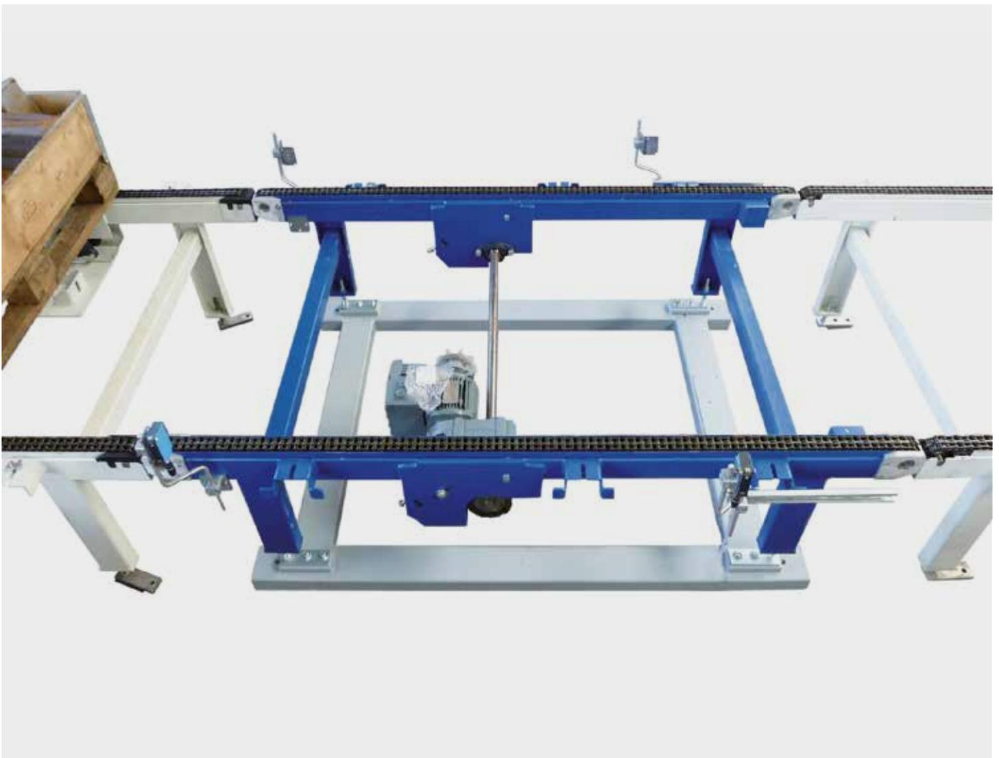
Structure de pesée 2812 avec convoyeur à chaîne monté
