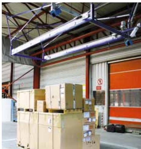
Module de de mesure plafond, balance au sol intégrée
