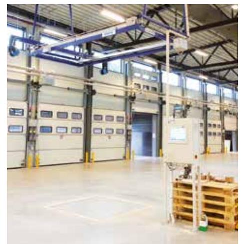
Module de de mesure plafond, balance au sol intégrée, unité de commande
