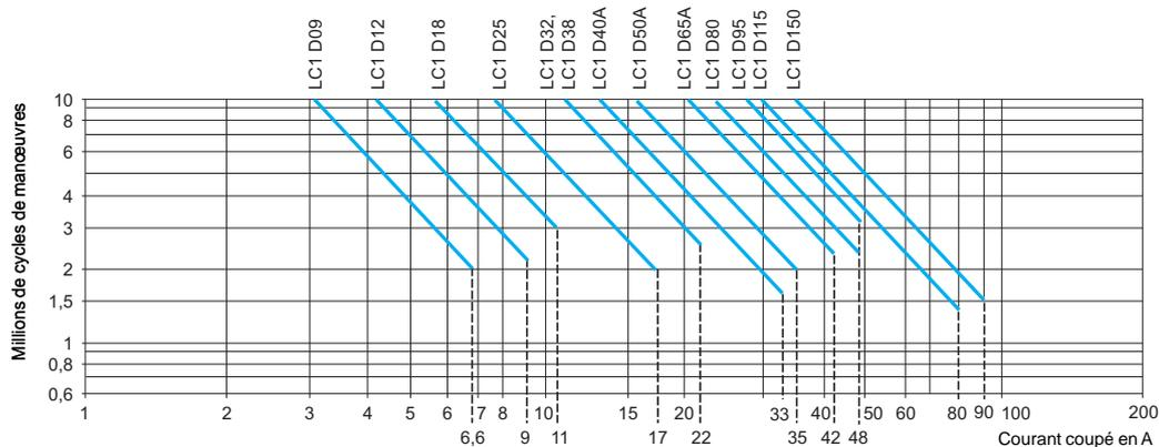
(1) Pour U<sub>e</sub> = 1000 V, utiliser les courbes 660/690 V sans dépasser le courant d'emploi correspondant à la puissance d'emploi indiquée sous 1000 V.
