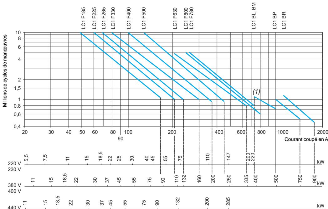
Puissance d'emploi en kW-50 Hz.
