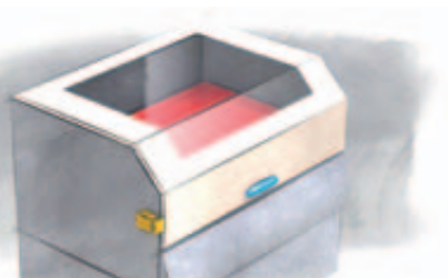
Protecteur fermé et bloqué, déblocage impossible
