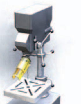
Protecteur réglable pour machine-outil (perceuse)
