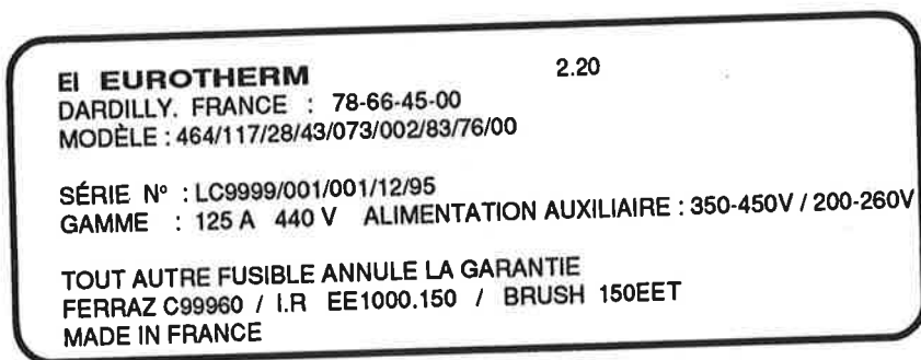
Figure 1-2 Exemple d'une étiquette d'identification du gradateur modèle 464 Les informations correspondent au gradateur 464, courant nominal 125 A, tension nominale 440 V, alimentation auxiliaire dans la plage 350 à 450 V, entrée 4-20 mA, conduction en «Angle de phase», contact d'alarme PLF fermé en alarme, unité livrée sans embase.
